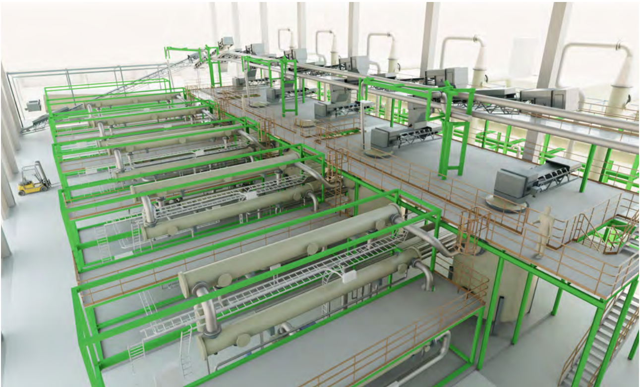
Rendering av en anläggning, som är baserad på Enviros teknologi, avsedd till att återvinna 30 000 ton uttjänta däck per år.
