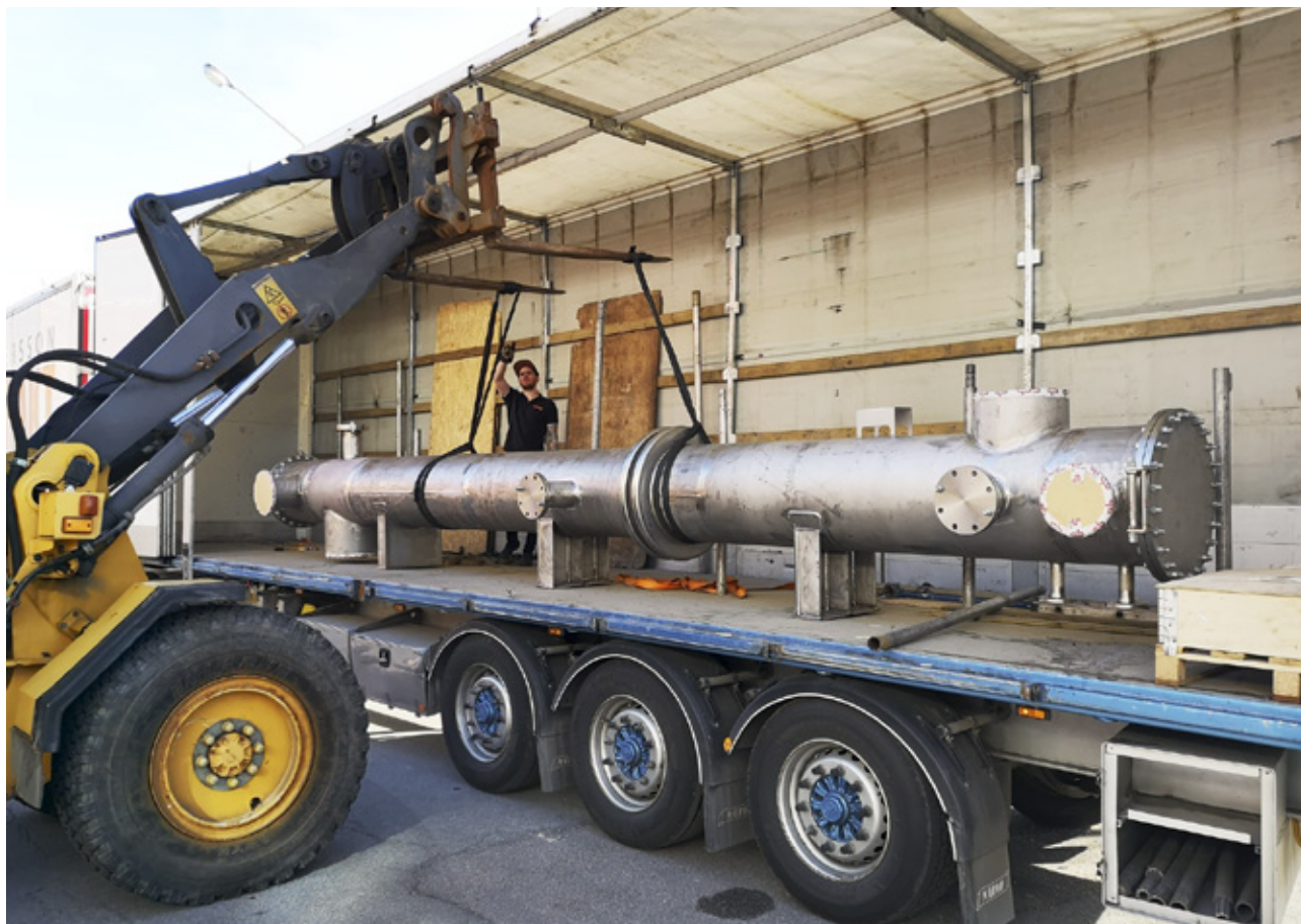
En ny värmeväxlare levereras till anläggningen i Åsensbruk.
