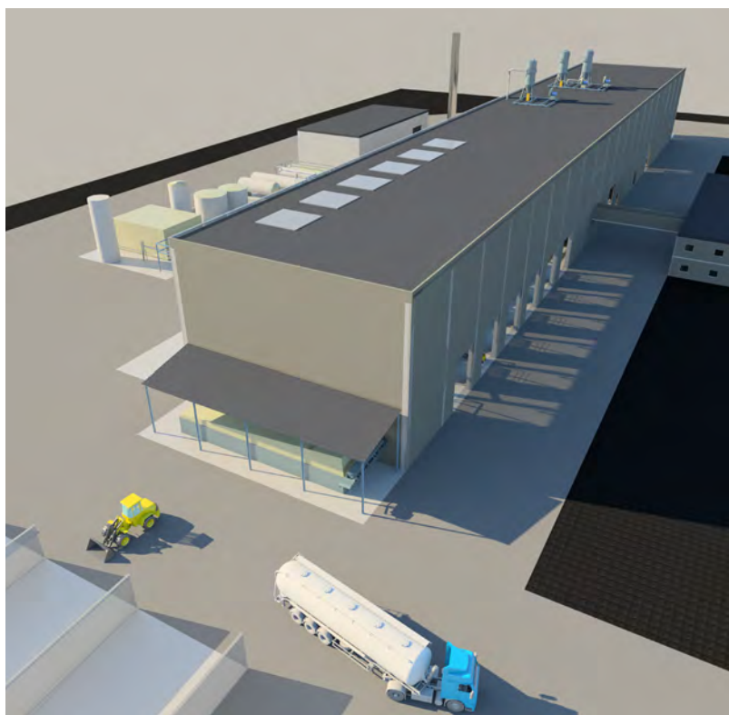
3D-avbildning av en anläggning avsedd för att återvinna 30 000 ton uttjänta däck per år.
