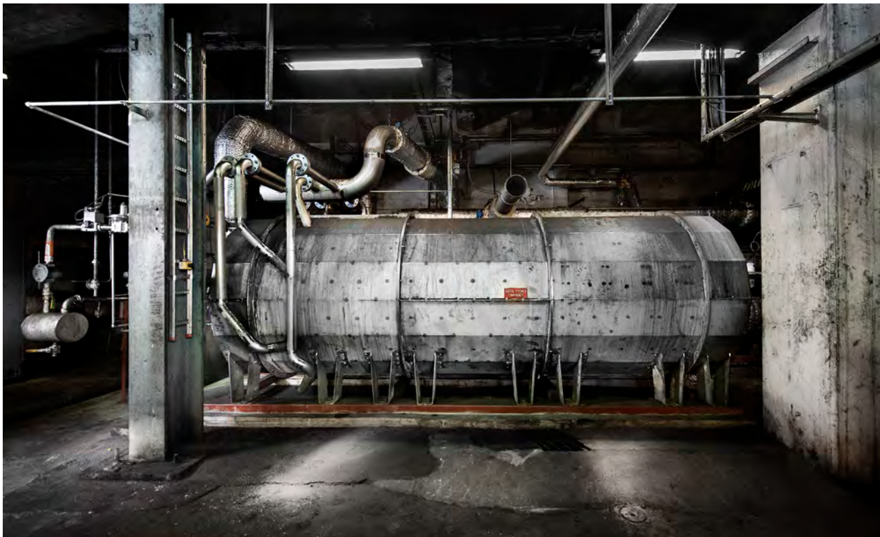
Bolagets nya brännkammare till pyrolysisprocessen.
