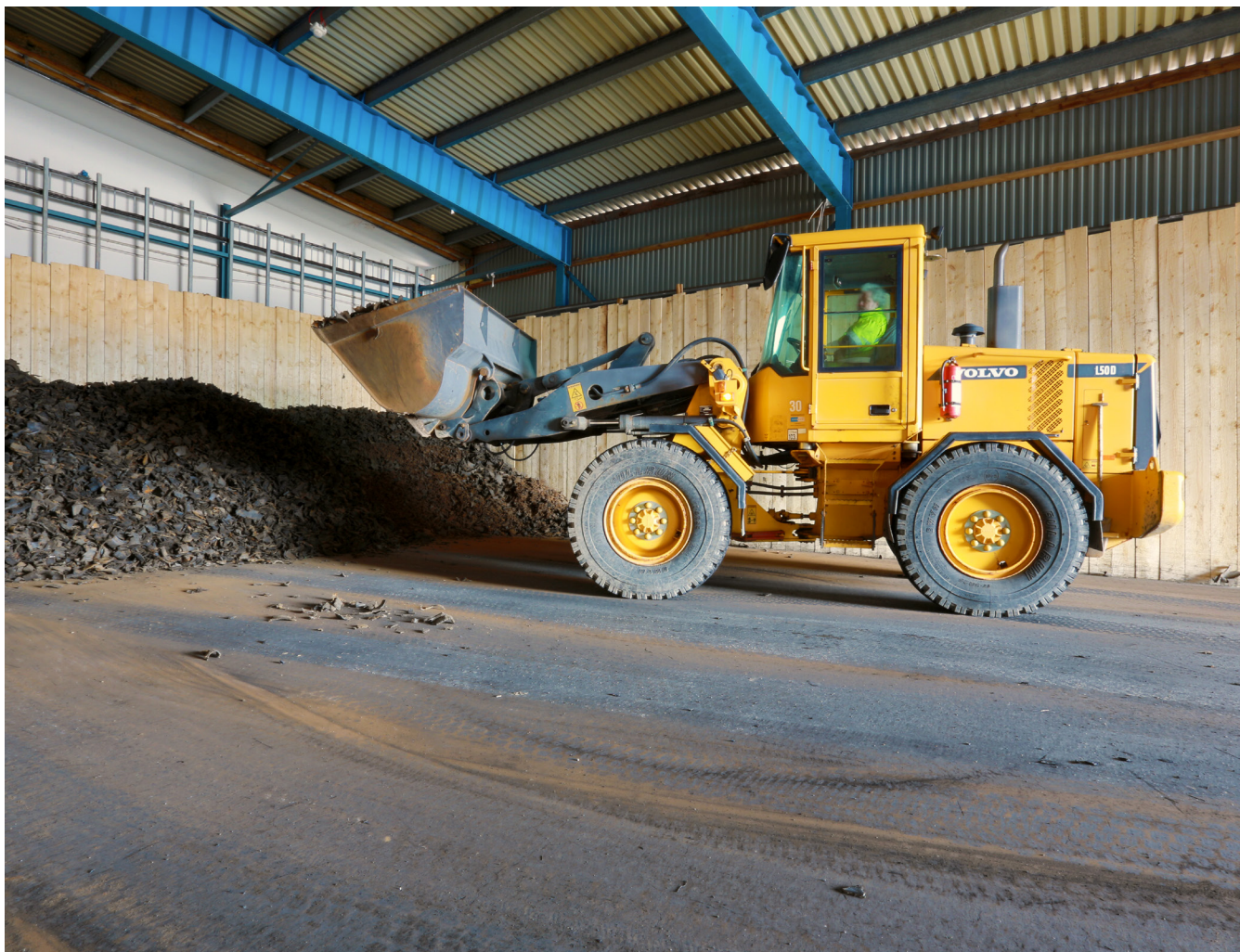
Lager av däckklipp i anläggningen i Åsensbruk. Däckklippen lastas från lagret över till inmatningen i återvinningsprocessen.
